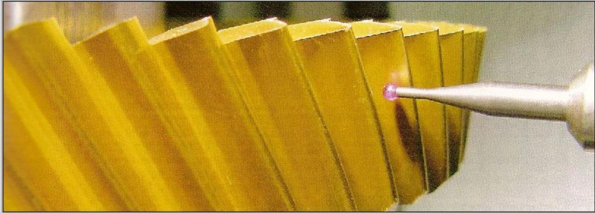
**Figura N°11-** *Controllo del profilo di un coltello elicoidale (cortesia Samputensili)*
